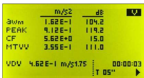
Pantalla de parámetros de evaluación globales según ISO 2631-2:2003
